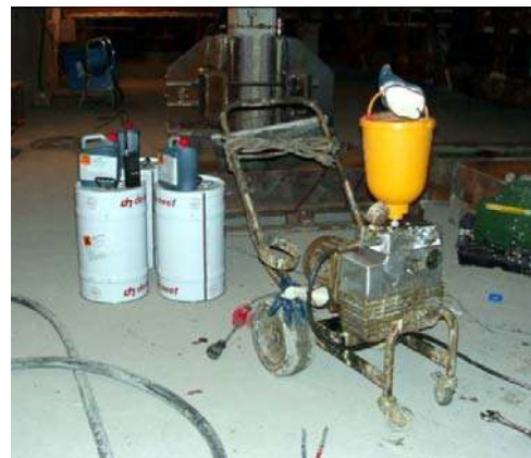
Kuva 1. TACSS- injektointipumppu, Wagner
